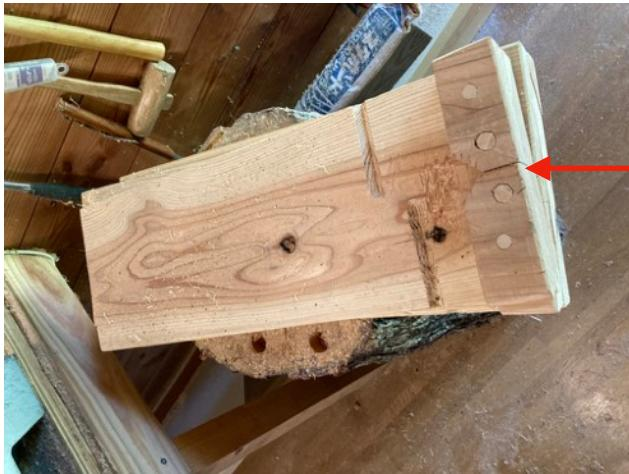
木の使い方を間違えているので、割れてしまった。ビスで補強して木工ボンドで接着
